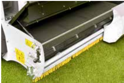
Vibrierende Siebplatten zur Filterung von Schmutz- partikeln
