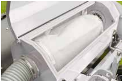
Vakuumsystem zum Entfernen von feinen Partikeln, wie z.B. Staub
