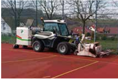
Reinigung mit Aufnahme des Schmutzwassers
