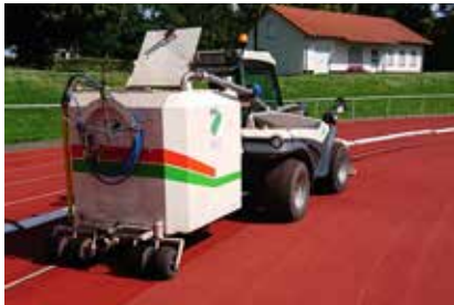
Wassertank mit 1000 Liter Fassungs- vermögen
